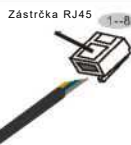
Obrázek 4.36 Obnažení izolace a připojení k zástrčce RJ45
